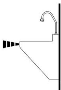
2. A medida que el usuario entra en el rango efectivo del sensor, el rayo se refleja hacia el receptor del sensor y activa la válvula solenoide. Fluye agua templada por la llave hacia el lavabo hasta que ya no se detecta al usuario.
