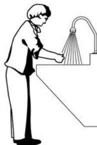
3. Cuando el usuario se retira del sensor, la luz deja de reflejarse al sensor. Entonces, una señal eléctrica desactiva la válvula solenoide, deteniendo el flujo de agua. El circuito entonces se reestablece automáticamente y está listo para el siguiente usuario.
