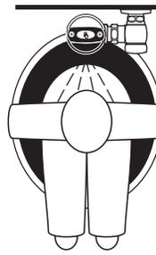
3. Cuando el usuario se retira del Sensor OPTIMA Plus el circuito espera 3 segundos (para prevenir descargas en falso), entonces inicia una señal eléctrica que opera el Solenoide. Esto inicia el ciclo de descarga para descargar la unidad. El circuito entonces se restablece automáticamente y está listo para el siguiente usuario.
