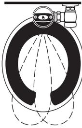
2. Al entrar el usuario en el rango efectivo del rayo (22 "a 42"), el rayo se refleja en la Ventana del Escáner de OPTIMA Plus y se transforma en un circuito eléctrico de bajo voltaje. Una vez activado, el Circuito de Salida continúa en modo de "espera" mientras el usuario permanezca dentro del rango efectivo de Sensor.
