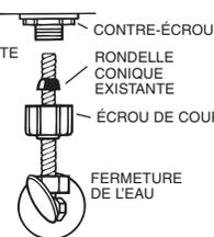
Utiliser la rondelle conique en place. La rondelle conique peut ne pas se sceller complètement en présence d'une conduite d'alimentation de type spiral.
