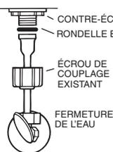
Utiliser l'écrou-raccord et la rondelle en place.
