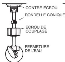
Ces pièces doivent être utilisées comme illustré afin d'assurer un raccordement étanche. L'utilisation des écrous-raccord déjà en place pourrait causer des fuites d'eau. La conduite ou le tuyau d'alimentation d'eau doit pénétrer d'au moins ½ po dans la tige fileté de la vanne (ne concerne pas la canalisation jointée).
