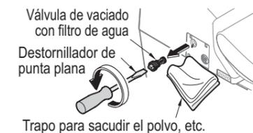
3. Después de vaciar el agua, vuelva a insertar la válvula de vaciado con filtro de agua. Ajústela firmemente con un destornillador de punta plana.
