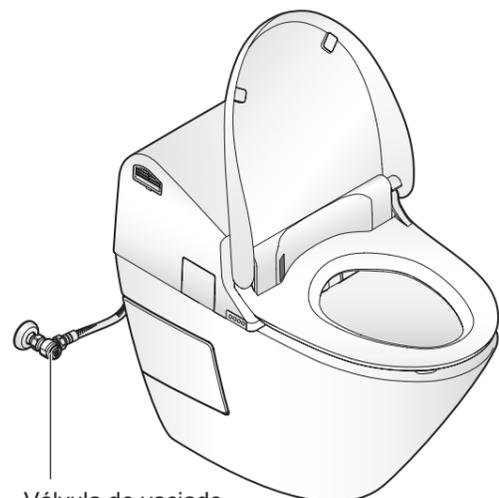
Válvula de vaciado
