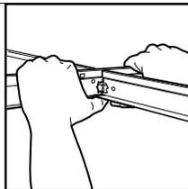
**Para retirar una T transversal,** empuje hacia arriba la T principal y gírela hasta que la T transversal sobresalga.
