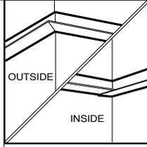
**Corte las esquinas.** En las esquinas exteriores, corte en inglete los ángulos de pared a 45 grados. En las esquinas interiores, corte los ángulos a 90 grados y colóquelos a tope.
