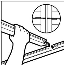
**Instale las T transversales.** Inserte las lengüetas en las ranuras en la T principal. Donde dos T transversales ocupen la misma ranura, inserte la segunda T transversal a la izquierda de la primera T transversal.
