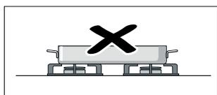
Μην θερμαίνετε ποτέ ένα μαγειρικό σκεύος (π.χ. ψηλή φόρμα, βαθύ ταψί, πέτρα ψησίματος γκριλ) με περισσότερους καυστήρες. Η προκύπτουσα συσσώρευση θερμότητας οδηγεί σε βλάβη στη συσκευή.
