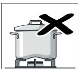
Μη χρησιμοποιείτε ένα παραμορφωμένο μαγειρικό σκεύος, το οποίο δε στέκεται σταθερά πάνω στη βάση εστιών. Τα σκεύη μπορούν να ανατραπούν.
