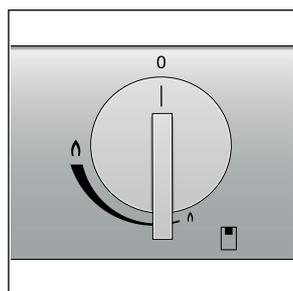
Las marcas en la maneta de mando muestra la asignación con el quemador correspondiente y el ajuste desde fuego pequeño hasta fuego grande. El ajuste es sin escalonamiento.
