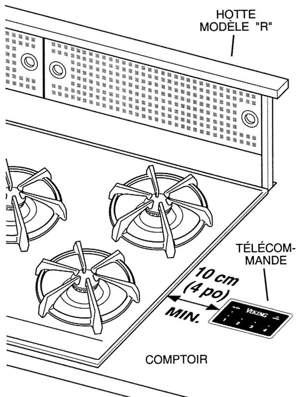
**Remarque :** La télécommande doit être montée dans le comptoir à au moins 10 cm (4 po) des éléments ou brûleurs.
