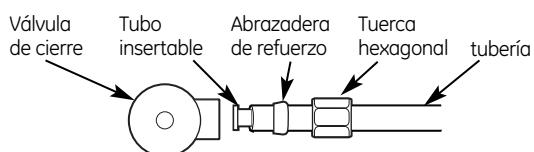
**NOTA:** Un ajuste excesivo hará que la tubería se separe de la unión.
