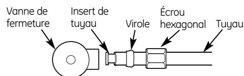
**NOTE :** Un serrage trop important provoquerait la séparation entre le raccord et le tuyau.
