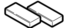
Bloques de relleno o pedazos de madera, si son necesarios para rellenar el gabinete (usados solamente en la instalación de gabinets apoyados)
