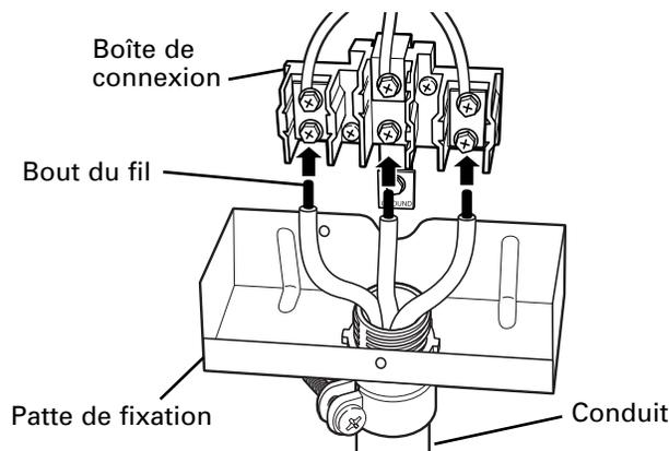
**Les fils utilisés, l'emplacement et l'isolement des épissures, etc. doivent se conformer aux bonnes pratiques d'installation des fils et aux codes locaux.**
