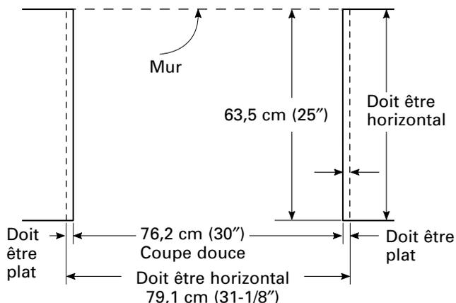
Si vous utilisez la trousse de remplissage, placez la pièce de remplissage en métal fournie avec la cuisinière dans l'arrière de la cuisinière comme le montre la figure ci-dessus. Engagez les 2 vis dans les trous du haut à l'extérieur arrière de la cuisinière au-dessus des aérateurs à lames et par les fentes de la garniture, en tenant la pièce de remplissage centrée sur le châssis du haut et en poussant vers l'avant pour réduire l'écart entre le bas du verre et la garniture de remplissage.
